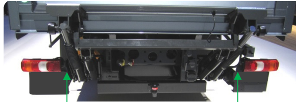
Beispiel: Anschluss Y-Adapter für RFS Exempel: Connecting Y-Adapter for RFS
